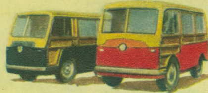
Электромобили «НАМИ» грузоподъемностью в 0,5—1,5 тонны.
